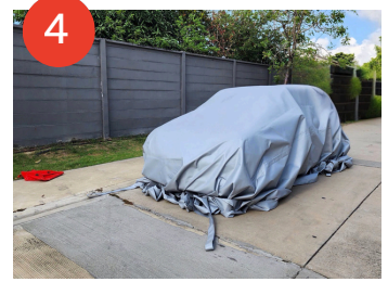
4.ตรวจสอบความสมบูรณ์ของการคลุม เดินตรวจสอบคันรถเพื่อให้แน่ใจว่าผ้าคลุมห่อหุ้มรถอย่างมิดชิด แล้วดำเนินการขอความช่วยเหลือเพื่อให้เจ้าหน้าที่ดับเพลิงเข้าควบคุมสถานการณ์ต่อไป
