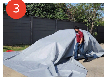
3.ปิดผ้าให้แน่นใต้ท้องรถ ใช้เท้าหรืออุปกรณ์ด้ามยาวกดขอบผ้าและสอดขอบผ้าเข้าใต้ท้องรถให้แน่นสนิท เพื่อจำกัดการไหลเวียนของอากาศ
